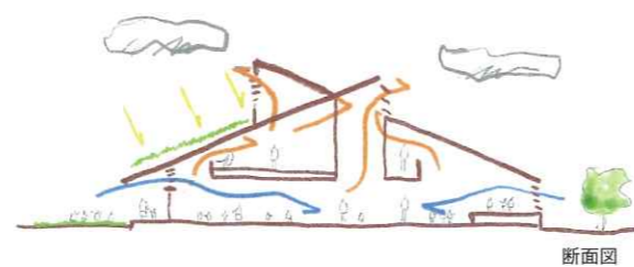
風と光の塔の熱廃棄システム
