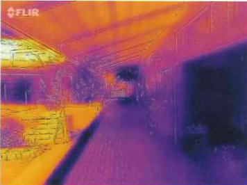
底によって太陽熱がカットされ、室内に冷気が溜まっている様子がわかる。(東京ゆりかご幼稚園 2018.07.09)
